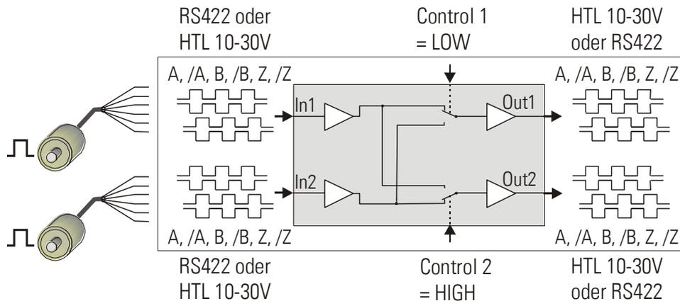
Beide Eingänge können individuell entweder auf das symmetrische Format A, /A, B, /B, Z, /Z oder auf das asymmetrische Format A, B, Z eingestellt werden (Pegel RS422, TTL oder HTL). Das Ausgangsformat kann für beide Ausgänge individuell gewählt werden. An den Ausgängen sind stets auch die invertierten Signale verfügbar, selbst wenn am Eingang nur A, B, Z verwendet werden.
