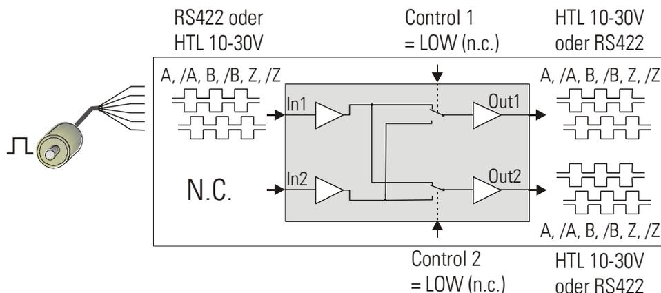
Der Encoder wird an Input 1 angeschlossen, Input 2 bleibt unbeschaltet.
