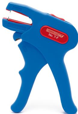
Die WEICON Abisolierzange No. 7-F eignet sich besonders gut für 2- oder 3-adrige PVC-isolierte Flachkabel von 0,75 – 4,0 mm<sup>2</sup>. Das Werkzeug verfügt über eine mehrfach verstellbare Feineinstellung. Die Zange verfügt über ein optisches Längenmaß von 8 - 24mm, Ein gut zugänglicher Seitenschneider ist in das Werkzeug integriert, der bis zu einem Kabeldurchmesser von 3 mm genutzt werden kann und die Klängen sind wechselbar.
