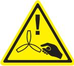
Verletzungsgefahr durch laufende Ventilatoren ohne Berührungsschutz
