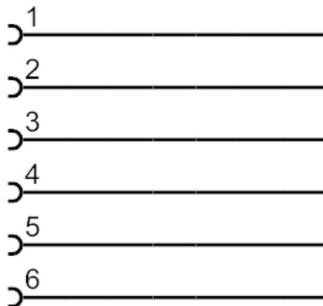
Steckverbindung: 1 x AMP-Stecker, gerade; Kontakte: vernickelt
