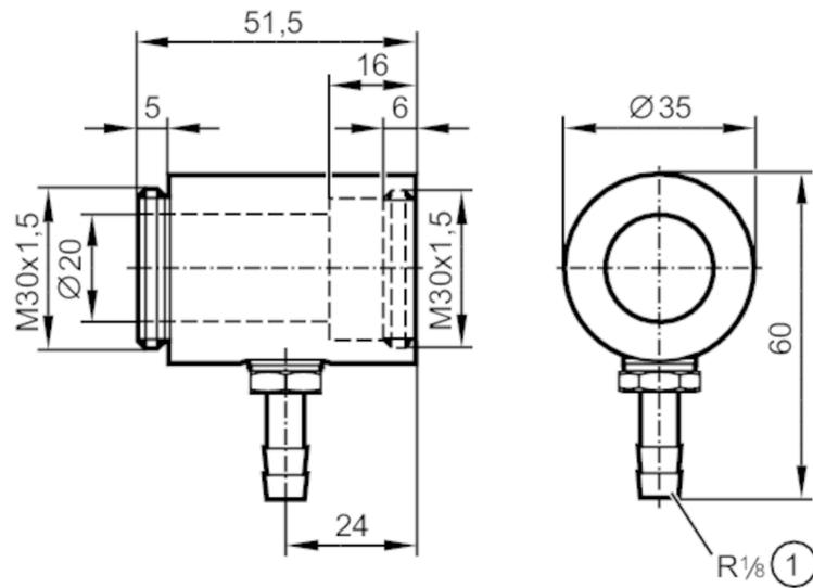
1 Schlauchtülle für Schlauch mit lichter Weite 8-9 mm
