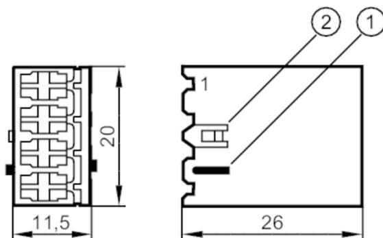
Abbildung zeigt Kontakt-Gehäuse mit geschlossenem Deckel
