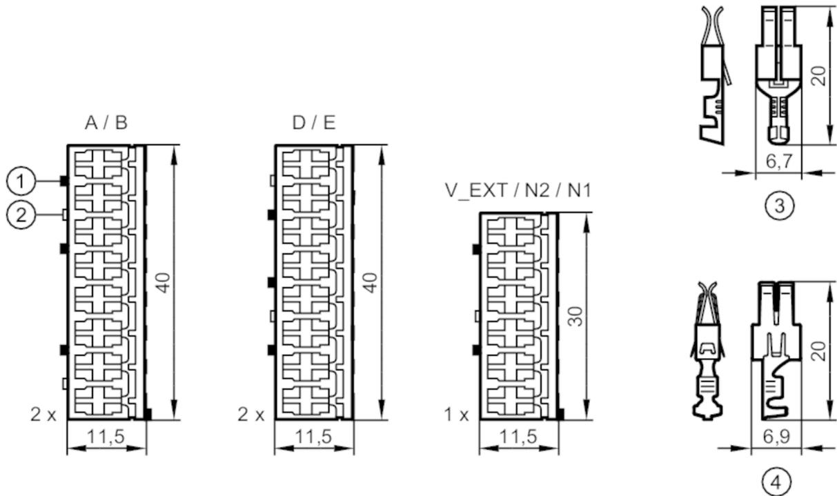
Abbildung zeigt Kontakt-Gehäuse mit geschlossenen Deckeln
