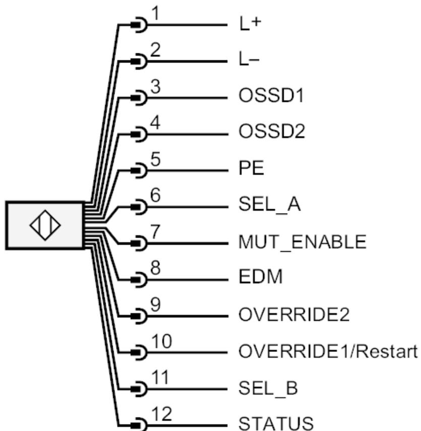
Steckverbindung: 1 x M12; Max. Leitungslänge: 100 m; bei Adernquerschnitt 1 mm<sup>2</sup>
