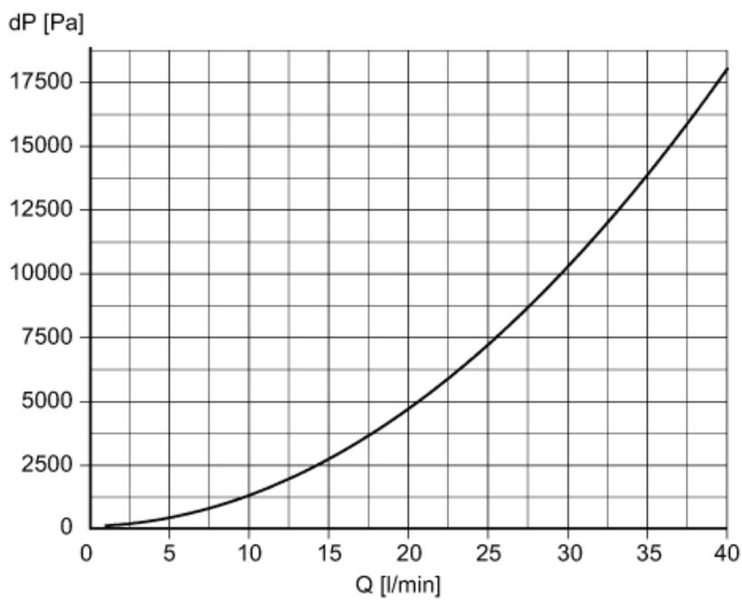
Druckverlust / Durchflussmenge
