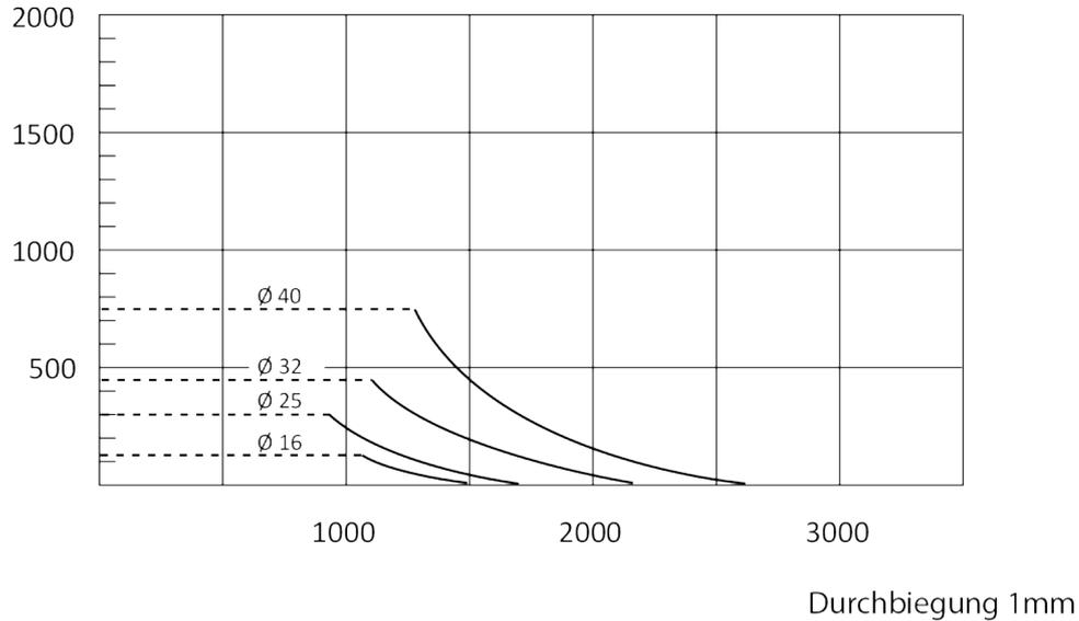
max. Stützlänge (SL) in mm - ohne Zwischenstütze/Mittelbefestigung
