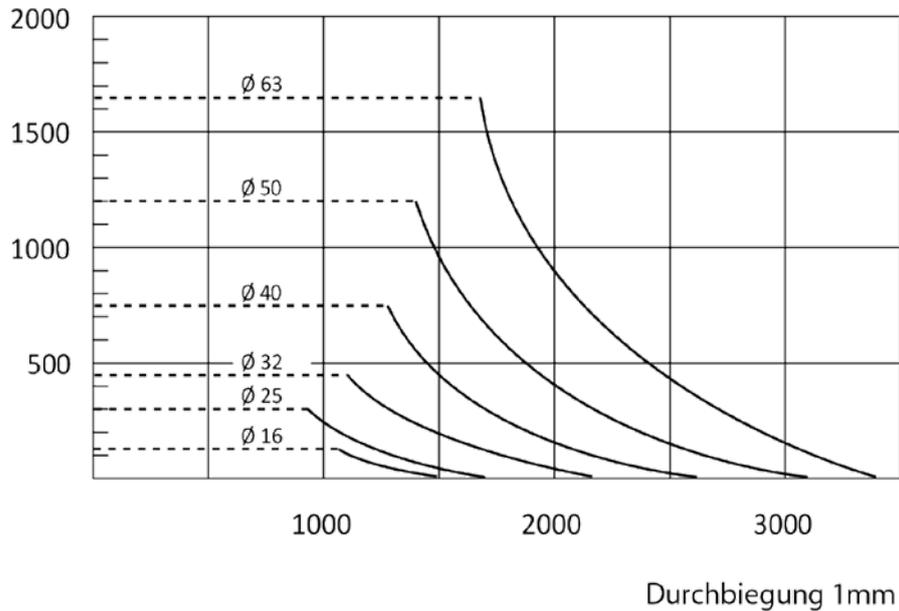
max. Stützlänge (SL) in mm - ohne Zwischenstütze/Mittelbefestigung
