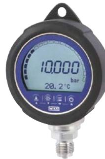
**Präzisionsdigitalmanometer mit Gehäuseschutzkappe,
