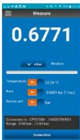
Über die App „myWIKa device“ und die Bluetooth®-Verbindung lässt sich das CPG1500 per Handy bequem für Kalibrier- und Log-Aufgaben konfigurieren. Während der Druckmessung wird der Wert in der benötigten Einheit direkt auf dem Handy angezeigt.
