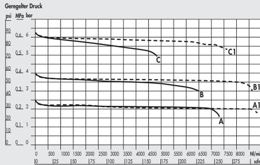
B1 = P Eingang 10 bar - P Ausgang 4 bar
