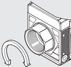
Die Buchsen 3/4" und 1" bei Baugröße 2 sind zu Montagezwecken frei drehbar ausgeführt.
