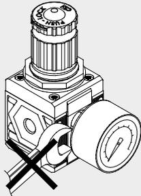
Keinen Schraubenschlüssel an Kegelgewinde verwenden. Nur von Hand montieren und einen Flüssigdichter (kein Teflon®) verwenden.
