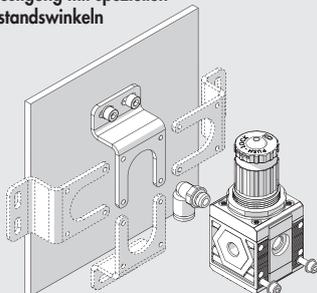
Der Winkel kann in beliebiger Position montiert werden. Die Verschraubungen können dann am Manometeranschluss hinten angebracht werden.
