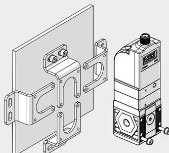
Der Winkel kann in beliebiger Position montiert werden.
