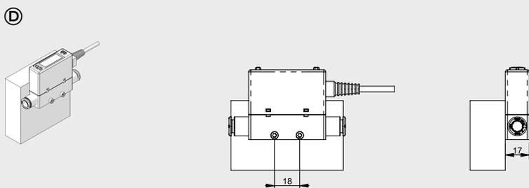
Seitliche Befestigung mit M3-Schrauben, Mindestlänge 23 mm.
