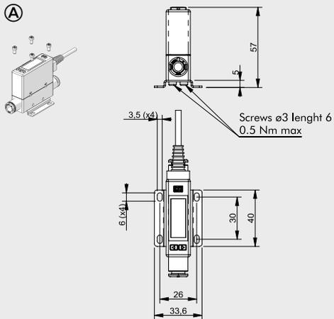
Befestigung mit der Halterung (Artikelnummer 90009A001) unter Verwendung der mitgelieferten Ø3-Schrauben (selbstschneidend) und M3-Schrauben
