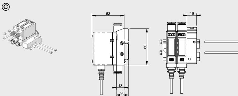
Mehrfachbefestigung auf Hutschiene mit Halterung (Artikelnummer 90009A002) unter Verwendung der seitlichen Ø3,4-Bohrungen mit M3-Schrauben und Muttern.
