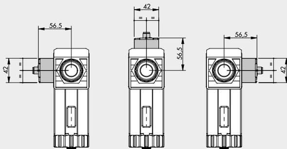
**ANMERKUNG:** Wird die FLUX hinter einem Syntesi®-Filter verwendet, montieren Sie diese in eine der drei in der Abbildung gezeigten Positionen.
