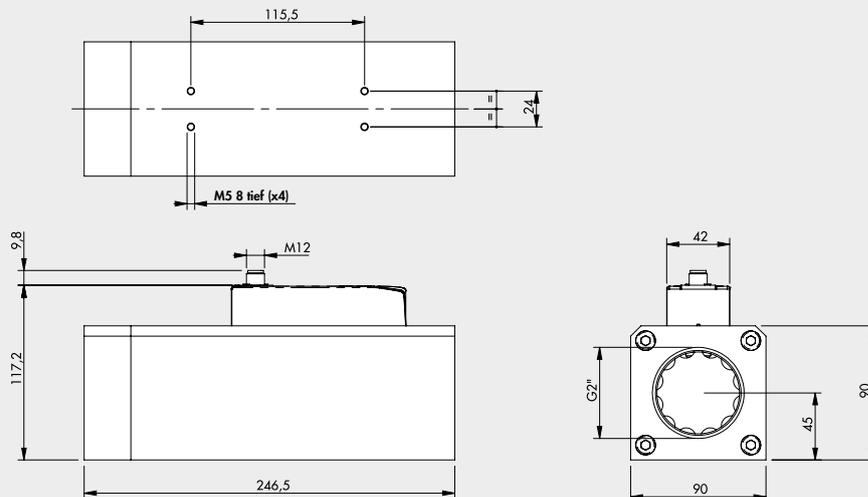
FLOWMETER SERIES FLUX WARTUNGSEINHEITEN
