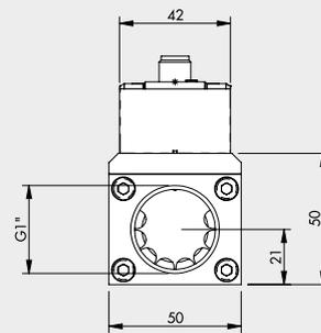
DURCHFLOßMESSER SERIE FLUX WARTUNGSEINHEITEN
