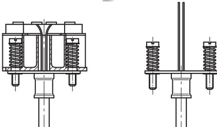
Abb. links: Messeinsatz mit aufgebautem Transmitter (hier: Typ T32)
