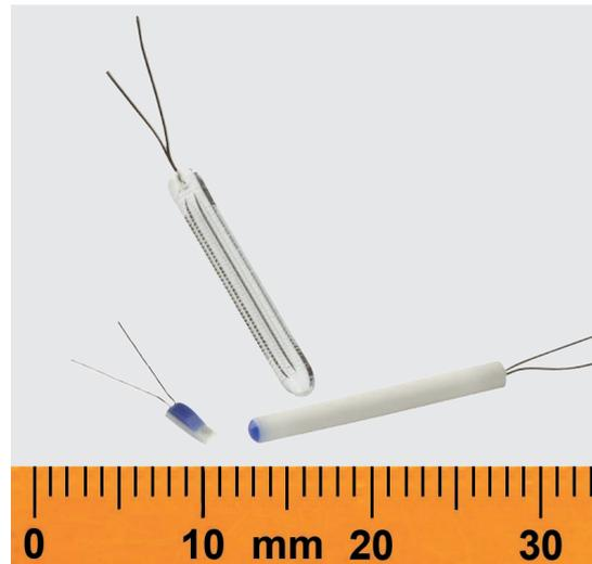
**Abb. links: Dünnschicht-Messwiderstand**
