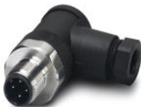
Sensor-/Aktor-Stecker, Stecker, gewinkelt, 4-polig, M12, Schraubanschluss, Edelstahlrändel, Kabelverschraubung Pg7
