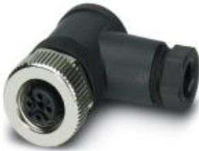
Sensor-/Aktor-Stecker, Buchse, gewinkelt, 4-polig, M12, A-codiert, Schraubanschluss, Metallrändel, Kabelverschraubung Pg7
