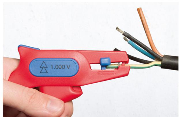
Mit der WEICON-Abisolierzange No. 6 werden alle flexiblen und massiven Leiter von 0,2 – 6,0 mm<sup>2</sup> abisoliert. Sie verfügt über einen verstellbaren Längenanschlag von 5 – 12 mm. Der Längenanschlag kann bei Bedarf herausgenommen werden. Dieses vollisolierte Werkzeug unterliegt der Stückprüfung gemäß IEC 60900 und hält einer Spannung von 1000 Volt stand.
