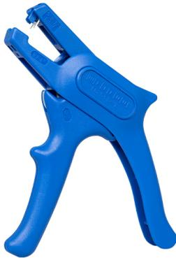
Die WEICON-Abisolierzange No. 5 Classic kann alle flexiblen und massiven Leiter von 0,2 – 6,0 mm<sup>2</sup> abisolieren. Ein gut zugänglicher Seitenschneider ist in das Werkzeug integriert, der bis zu einem Kabeldurchmesser von 2 mm genutzt werden kann. Die Klinsen sind wechselbar. Das geringe Gewicht der No. 5 Classic sorgt für ein ermüdungsfreies Arbeiten.
