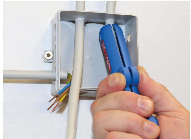
Der Rundkabel-Stripper No. 13 sorgt für ein sicheres und komfortables Entmanteln aller gängigen Rund- und Feuchtraumkabel mit einem Durchmesser von 6,0 - 13,0 mm. (z.B. NYM-Kabel 3 x 1,5 mm<sup>2</sup> bis 5 x 2,5 mm<sup>2</sup>) Die Schnitttiefe muss nicht extra manuell reguliert werden. Der neue Arbeitsbereich eignet sich somit auch für kleinere Leitungsdurchmesser ab 6 mm, wie z.B. 3 x 0,75 mm<sup>2</sup>. Durch die ergonomische Griffform ist das Werkzeug besonders gut in der Handhabung.
