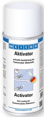
nicht aktivierte Oberfläche auftragen und die zu klebenden bzw. zu fixierenden Teile unter Druck fügen. Überschüssige Klebstoffreste besprühen, aushärten lassen und ggf. entfernen. Aktivator Spray kann lackierte Oberflächen sowie Thermoplaste angreifen! Vor der Anwendung Oberflächenverträglichkeit prüfen.
