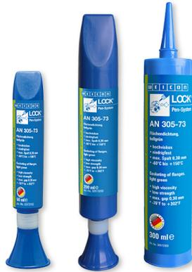
Bei Dichtanwendungen (Rohrverschraubungen) WEICONLOCK ringförmig auf das Gewinde auftragen. Rohrgewinde verschrauben und bis zur gewünschten Ausrichtung anziehen. WEICONLOCK, das bereits mit Metall in Berührung gekommen ist, nicht in die Flasche zurückgießen. Bereits kleinste Metallteilchen führen zur Aushärtung in der Flasche. In der Serienfertigung empfiehlt sich daher der Einsatz von Dosiergeräten.
