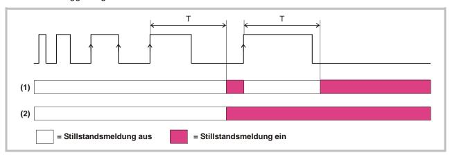
Zur Erkennung des Stillstandes muss zunächst der Zeitabstand zwischen zwei positiven Flanken größer als die vorgegebene Stillstandszeit "T" werden.
