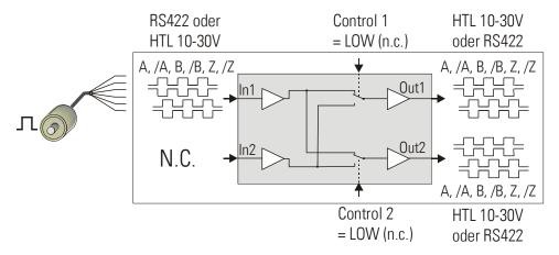
Der Encoder wird an Input 1 angeschlossen, Input 2 bleibt unbeschaltet. Der Eingang kann entweder auf das symmetrische Format A, /A, B, /B, Z, /Z oder auf das asymmetrische Format A, B, Z eingestellt werden (Pegel RS422, TTL oder HTL). Das Ausgangsformat kann für beide Ausgänge individuell gewählt werden.
