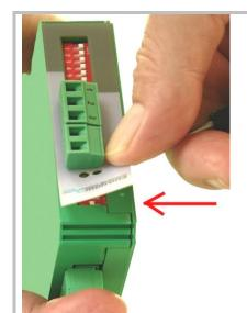
Schieber 1 ist zuständig für alle Kanäle von Eingang 1
