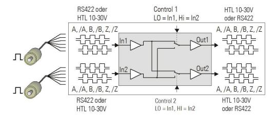
Beide Eingänge können individuell entweder auf das symmetrische Format A, /A, B, /B, Z, /Z oder auf das asymmetrische Format A, B, Z eingestellt werden (Pegel RS422, TTL oder HTL).
