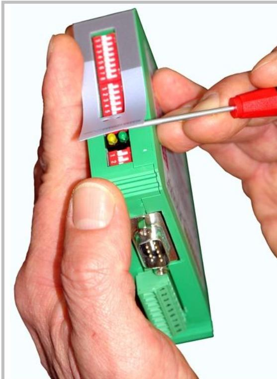
Schieber 1 ist zuständig für Spur A
