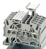
TOPJOB*S-Gruppenschildträger (2009-193) hier bestückt mit Beschriftungsstreifen, verwendbar für alle TOPJOB*S-Reihenklemmen der Serien 2000 bis 2016. Nicht über eine Abschlussplatte hinweg setzen!
