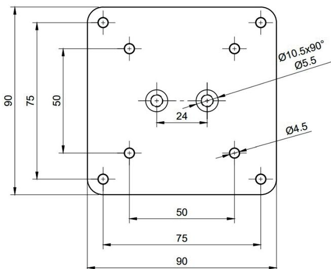
**Bohrzeichnung für Anschraubfuß**
