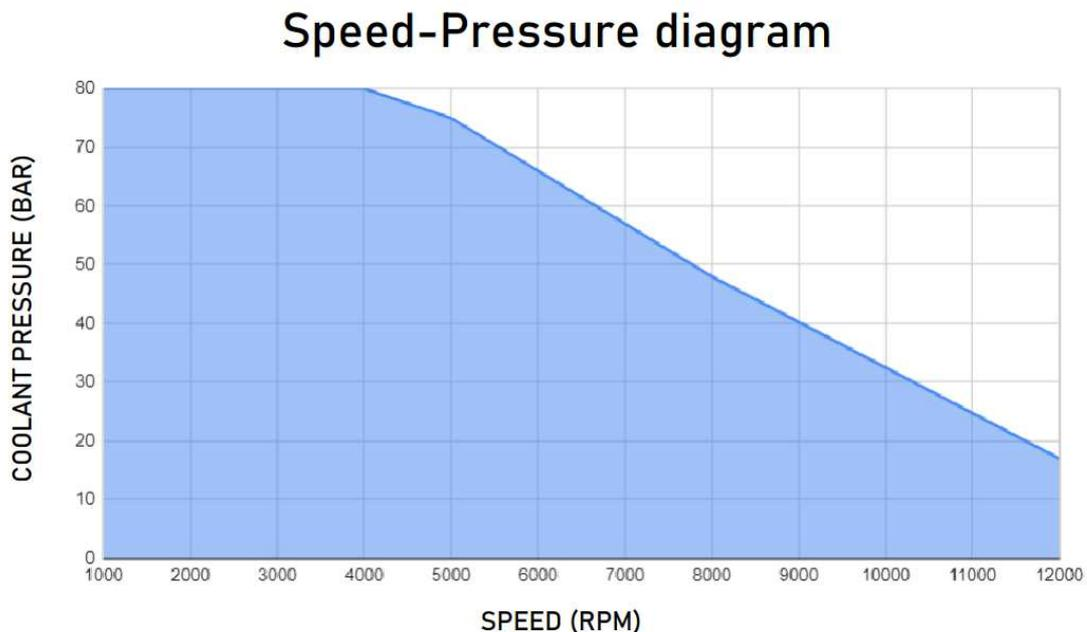
Per garantire al motorizzato un corretto funzionamento, è necessaria una filtrazione del liquido refrigerante in ingresso alla macchina di 30 µm.
