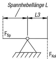
Effektive Spannkraft  $F_{Sp}$  in Abhängigkeit zur Kolbenkraft  $F_{Kol}$  und Spannhebellänge  $L$
