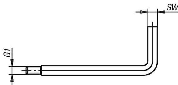
Spezieller 6-kt-Schraubendreher mit Gewindezapfen. Dieser wird in das Gewinde G1 der Zylinderschraube eingeschraubt, um das Rundspannelement zu positionieren bzw. zu lösen.
